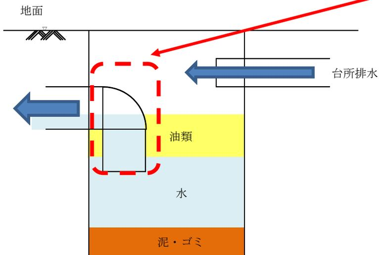
汚れが多い場合には矢印の部分を中心に左右に回しながら手前に引き、取り外して清掃を行って下さい。
