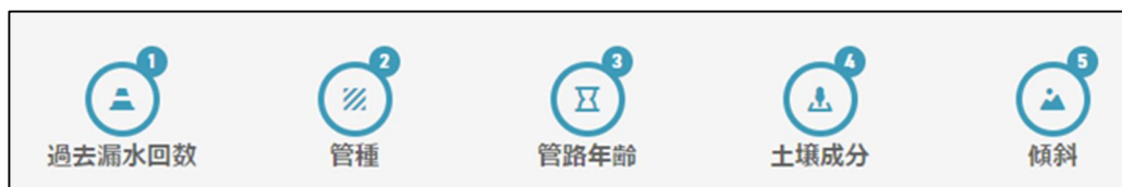
図10 漏水相関因子上位5因子
