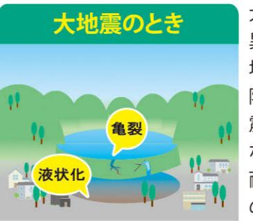
大地震のときに、ため池の堤防が異常な力を受け亀裂が生じたり、地盤の液状化により決壊する危険性があります。比較的小さな地震でも、堤防の内部に生じた亀裂などにより強度が低下し、水圧に耐えきれず決壊に至ることがあるので注意が必要です。
