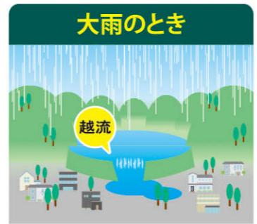
大雨のとき、ため池の水位が上昇し堤防を越えた水の勢いによって堤防が侵食され、決壊することがあります。竹や流木が洪水吐の断面を閉塞せると、堤防を越流しやすくなり、侵食・崩壊の危険性は、一層高くなります。
