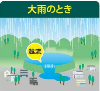
大雨のとき、ため池の水位が上昇し堤防を越えた水の勢いによって堤防が侵食され、決壊することがあります。竹や流木が洪水吐の断面を閉塞せると、堤防を越流しやすくなり、侵食・崩壊の危険性は、一層高くなります。
