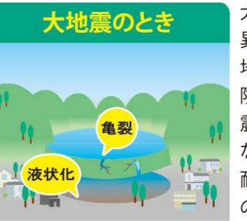
大地震のときに、ため池の堤防が異常な力を受け亀裂が生じたり、地盤の液状化により決壊する危険性があります。比較的小さな地震でも、堤防の内部に生じた亀裂などにより強度が低下し、水圧に耐えきれず決壊に至ることがあるので注意が必要です。
