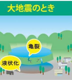
大地震のときに、ため池の堤防が異常な力を受け亀裂が生じたり、地盤の液状化により決壊する危険性があります。比較的小さな地震でも、堤防の内部に生じた亀裂などにより強度が低下し、水圧に耐えきれず決壊に至ることがあるので注意が必要です。
