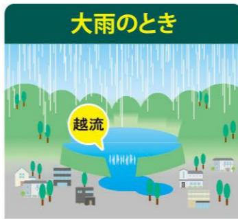
大雨のとき、ため池の水位が上昇し堤防を越えた水の勢いによって堤防が侵食され、決壊することがあります。竹や流木が洪水吐の断面を閉塞させると、堤防を越流しやすくなり、侵食・崩壊の危険性は、一層高くなります。
