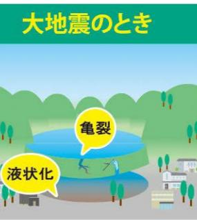
大地震のときに、ため池の堤防が異常な力を受け亀裂が生じたり、地盤の液状化により決壊する危険性があります。比較的小な地震でも、堤防の内部に生じた亀裂などにより強度が低下し、水圧に耐えきれず決壊に至ることがあるので注意が必要です。
