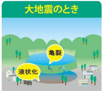
大地震のときに、ため池の堤防が異常な力を受け亀裂が生じたり、地盤の液状化により決壊する危険性があります。比較的小な地震でも、堤防の内部に生じた亀裂などにより強度が低下し、水圧に耐えきれず決壊に至ることがあるので注意が必要です。
