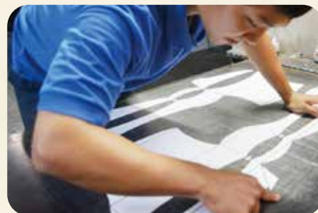
紙器製作時に必要な型板。細かな調整は人の手でないと不可能である。
