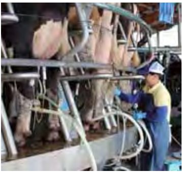
日本で最初に外国製の搾乳機（ロータリーパーラー）を導入し、搾乳スピードが圧倒的に早くなった。
