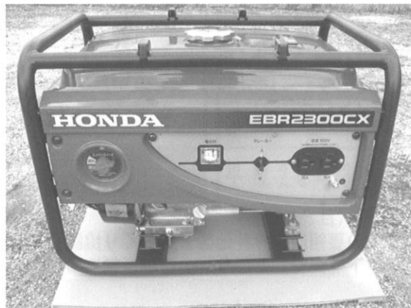
新しく導入されたエンジン式発電機
