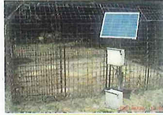
カメラ、センサー、データ送信機器とソーラーパネルを備えた島内で1基しかない最新の罠です。
